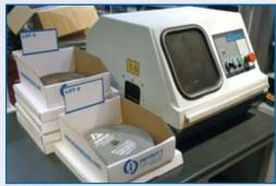
**BUEHLER** ABRASIVE CUTTER, MODEL ABRASIMET2
